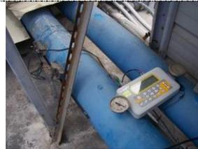
冷卻水塔散熱效率量測
