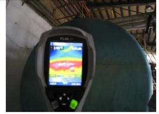
鍋爐爐壁溫度量測
